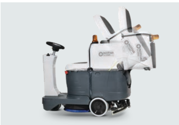
Depósito de recuperación totalmente inclinable que facilita el acceso al compartimento de la batería y al sistema Ecoflex.
