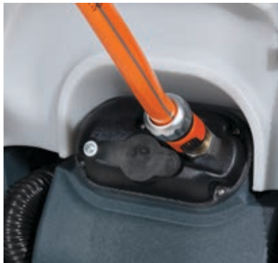
Sistema de llenado con cierre automático cuando el depósito está lleno (opcional).
